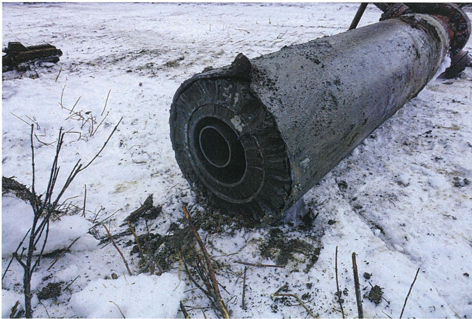
Tête de puits et coffrage enlevés au cours de la procédure d'abandon, Cameron Hills, février 2024. (BOROPG)
